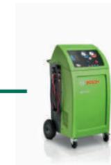
**Le unità per il servizio su impianti di climatizzazione offerti da Bosch** permettono all'operatore di riutilizzare il 99% del liquido refrigerante presente nel veicolo. Di conseguenza, non solo potrete risparmiare tempo e denaro ma anche migliorare l'efficienza e la qualità del servizio della vostra officina, essendo anche ecocompatibili e conservatori delle risorse.
