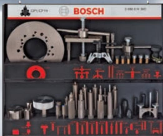
Reparatur von Common-Rail-Hochdruckpumpen der Baureihen CP1 und CP1H
