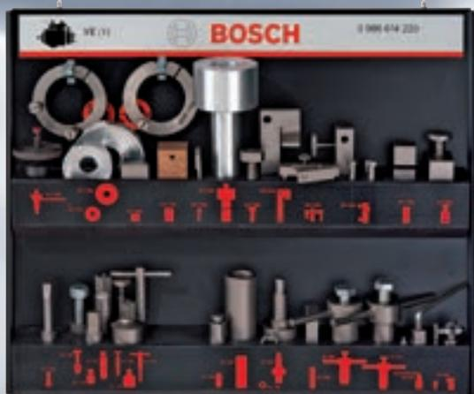
Werkzeugsatz für die Reparatur von mechanisch geregelten (VE.F) und elektronisch geregelten (VE.E und VE.M) Verteilereinspritzpumpen
