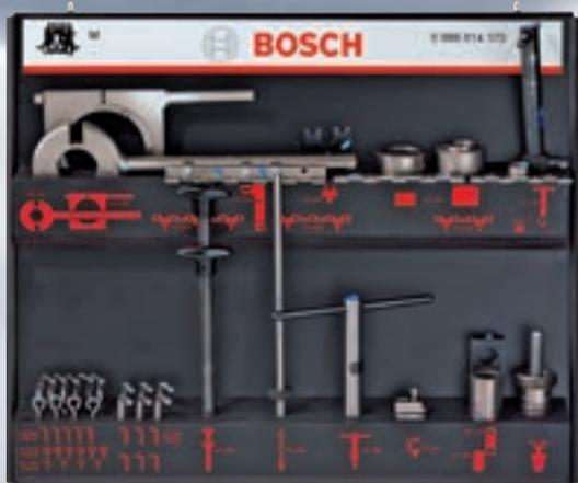
Reparatur von Reiheneinspritzpumpen der Baureihen PE(S) ..M.. mit und ohne Förderbeginnegeber-System (FBG-System), **ohne** Regler, atmosphärendruckabhängigen Volllastanschlag (ADA) und Spritzversteller
