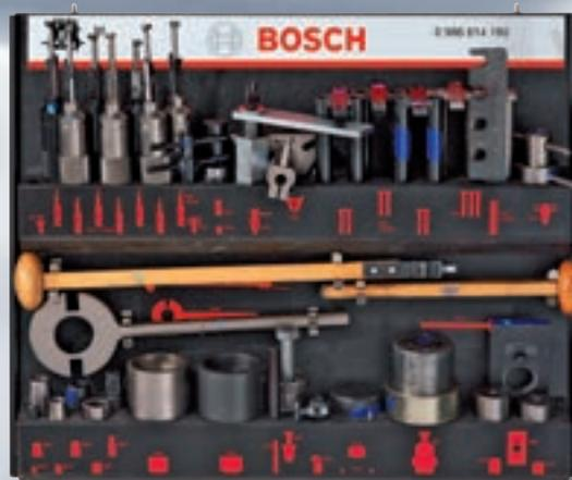
Reparatur von Reiheneinspritzpumpen der Baureihen PE(S) ..MW.. S1 (8 mm Hub) ..S100 (10 mm Hub) und ..S1500, **ohne** Regler, ladedruckabhängigen Volllastanschlag (LDA) und Spritzversteller
