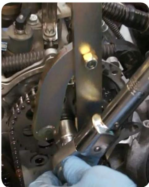
**Attenzione!** Il bullone dell'albero a camme non ha una fessura tra l'albero a camme e il bullone stesso. Non utilizzare mai lo strumento di bloccaggio per bloccare l'albero a camme quando si rimuove il bullone dell'albero a camme! Le forze elevate potrebbero distruggere lo strumento di bloccaggio all'interno del motore e danneggiare l'albero a camme!
