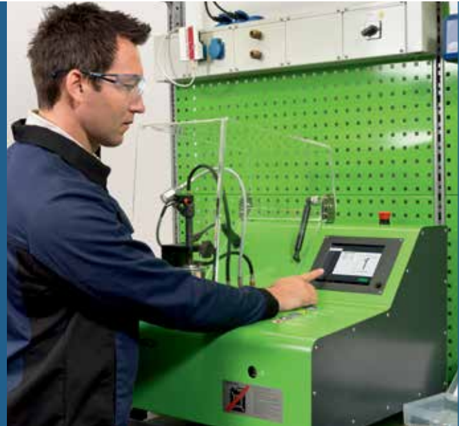
Einfache Bedienung über Touchscreen auch ohne Vorkenntnisse in der Prüfung von Diesel-Injektoren
