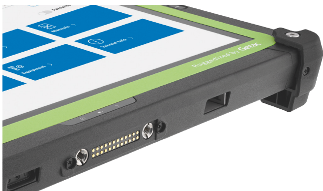
Interfaccia per connessione sicura con tastiera o docking station corrispondente
