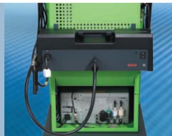
Il sistema FSA 740 può essere efficacemente integrato con BEA 050 e RTM 430 analisi gas di scarico, permettendo così un'analisi dettagliata delle emissioni per motori benzina e Diesel.
