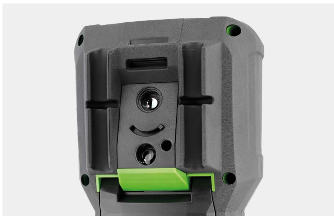
Pratici accessori installati sul retro del BIT 1000: termocamera, laser e luce di lavoro
